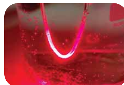
Biofotoniczny czujnik do badań przesiewowych w celu wykrycia biomarkerów urosepsy
