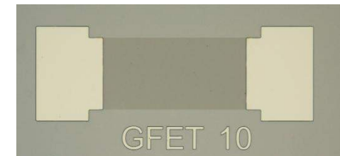
Powiększenie mikroskopowe badanej struktury – tranzystora FET z widocznymi kontaktami źródła i drenu oraz jednoatomową warstwą grafenu między nimi, stanowiącą warstwę gazoczułą
