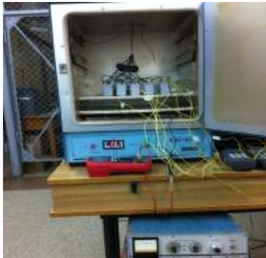
Unikalne stanowisko pomiarowe do nieniszczącej oceny kondensatorów foliowych
