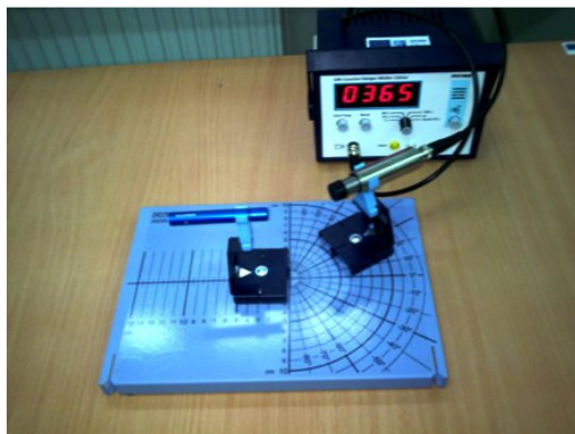
Rys. 29a.4. Geometria pomiarów do badania rozkładu katowego wiązki promieniowania.
