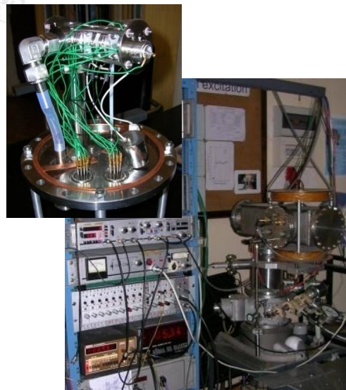
Aparatura pomiarowa do badania fragmentacji cząsteczek biologicznych.
