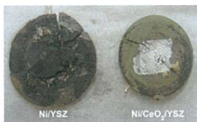
Rys.2: Zdjęcia anod po reformingu parowym n-butanu: Ni-YSZ (po 20h) oraz Ni-CeO 2 -YSZ (po 45h) [19].
