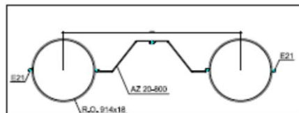
UKŁAD ŚCIANY KOMBINOWANEJ
