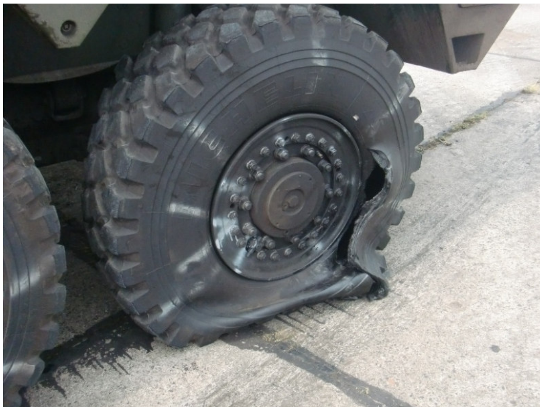
Rys. 17. Przykład rozerwanej opony w Kołowym Transporterze Opancerzonym Rosomak po najechaniu na improwizowany ładunek wybuchowy (IED) – jeden z wielu eksperymentów przeprowadzonych w ramach projektu ROSOMAK [PK4]
