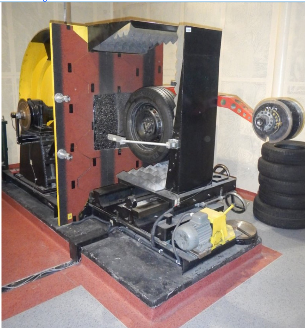
Rys. 2. Bęben o średnicy 1,7 m pokryty repliką nawierzchni APS4 oraz nawierzchnią PERS-HET
