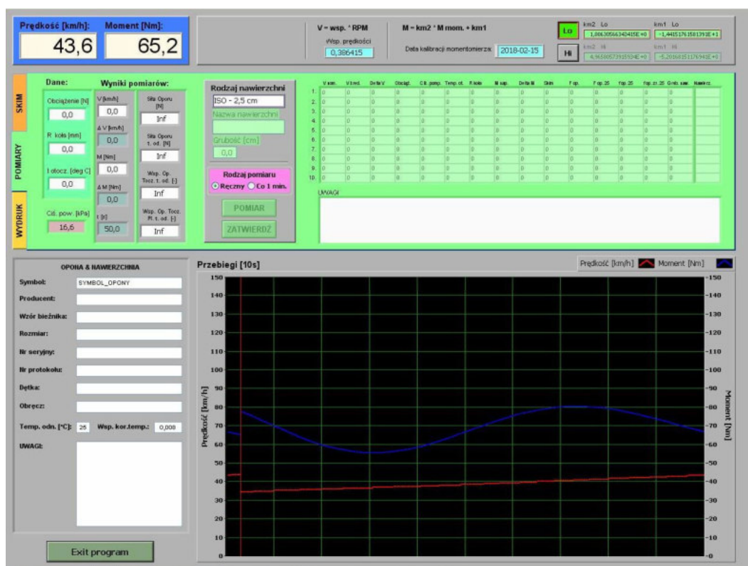
Rys. 19. Zrzut ekranu autorskiego programu do prowadzenia pomiarów oporu toczenia przy wykorzystaniu maszyny bieżnej z bębniem o średnicy 2 m
