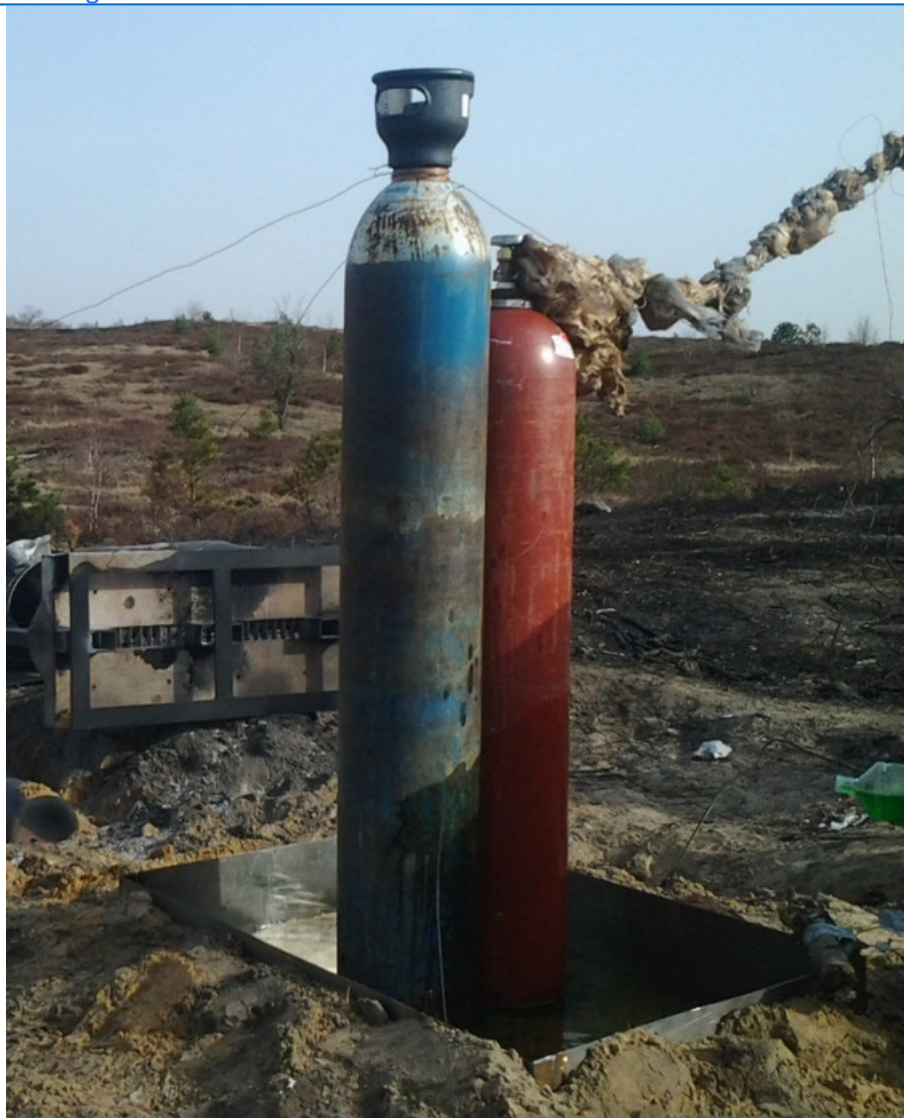
Rys. 14. Butle z tlenem i wodorem wraz z instalacją pomiarową ustawione w wannie wypełnionej mieszaniną benzyny i oleju napędowego – jeden z wielu eksperymentów przeprowadzonych w ramach projektu BLOW [PK6]
