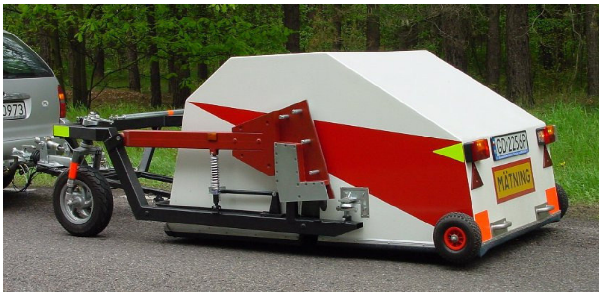
Rys. 1. Przyczepa do pomiaru hałasu opon i nawierzchni drogowych Tiresonic Mk3
