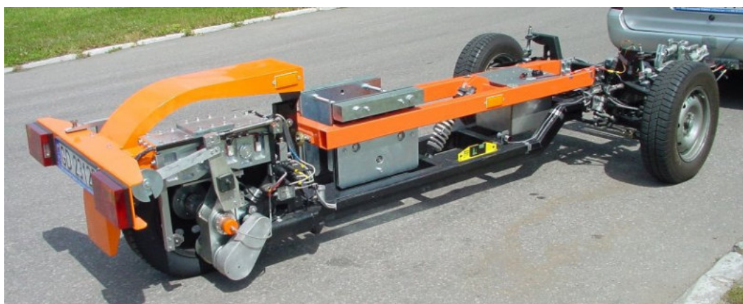
Rys. 5. Pierwsza przyczepa do pomiaru oporu toczenia ( R^2Mk.1 ) zbudowana w Katedrze Pojazdów i Maszyn Roboczych – pierwotna wersja przyczepy
