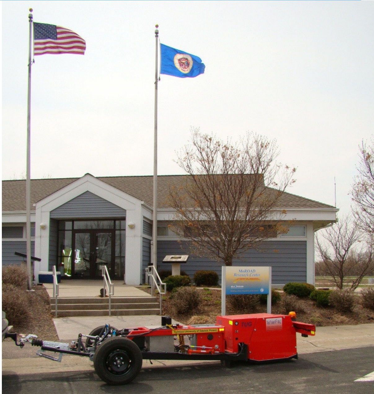
Rys. 7. Nowa przyczepa doświadczalna R^2Mk.2 do pomiaru oporu toczenia podczas badań w MnRoad.
