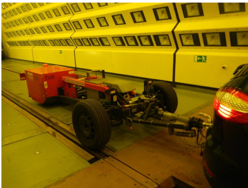
Rys. 6. Przyczepa do pomiaru oporu toczenia R 2 Mk.2 podczas badań w tunelu aerodynamicznym w Austrii
