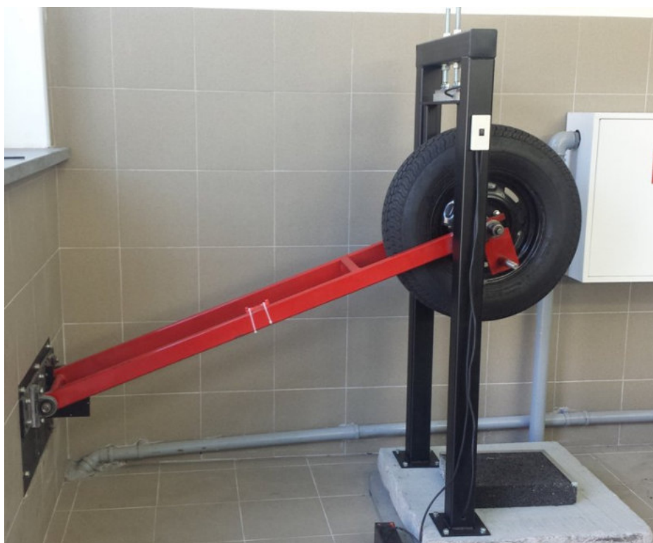
Rys. 23. Stanowisko do laboratoryjnej oceny oporu toczenia opon samochodowych na nawierzchniach drogowych o różnej teksturze i sztywności
