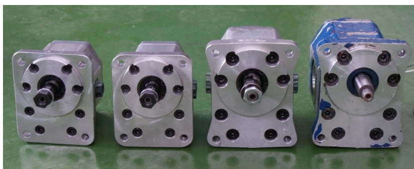
Rys. 6. Niektóre badane pompy zębate [R. Jasiński: monografia M-1.]
