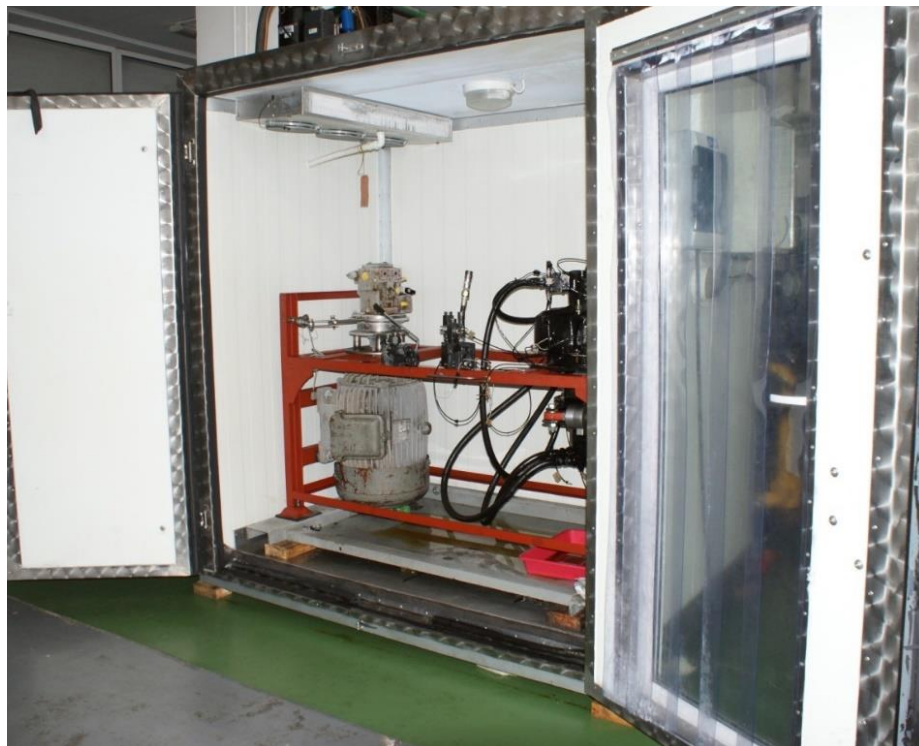
Rys. 1. Stanowisko badawcze umieszczone w komorze niskich temperatur [R. Jasiński: monografia M-1.]
