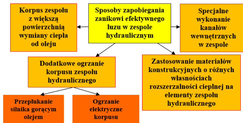
Rys. 19. Sposoby zapobiegania zanikowi efektywnego luzu w zespole hydraulicznym uruchamianym w niskich temperaturach otoczenia [R. Jasiński: monografia M-1.]
