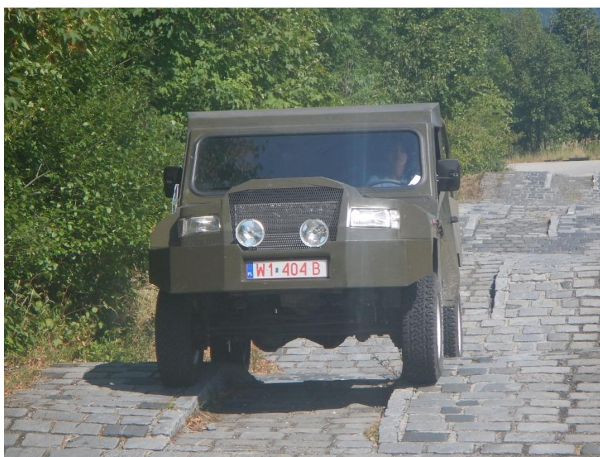
Rys.5 Badanie wpływu równości nawierzchni na opór toczenia na ekstremalnej nawierzchni na torze doświadczalnym TATRA.
