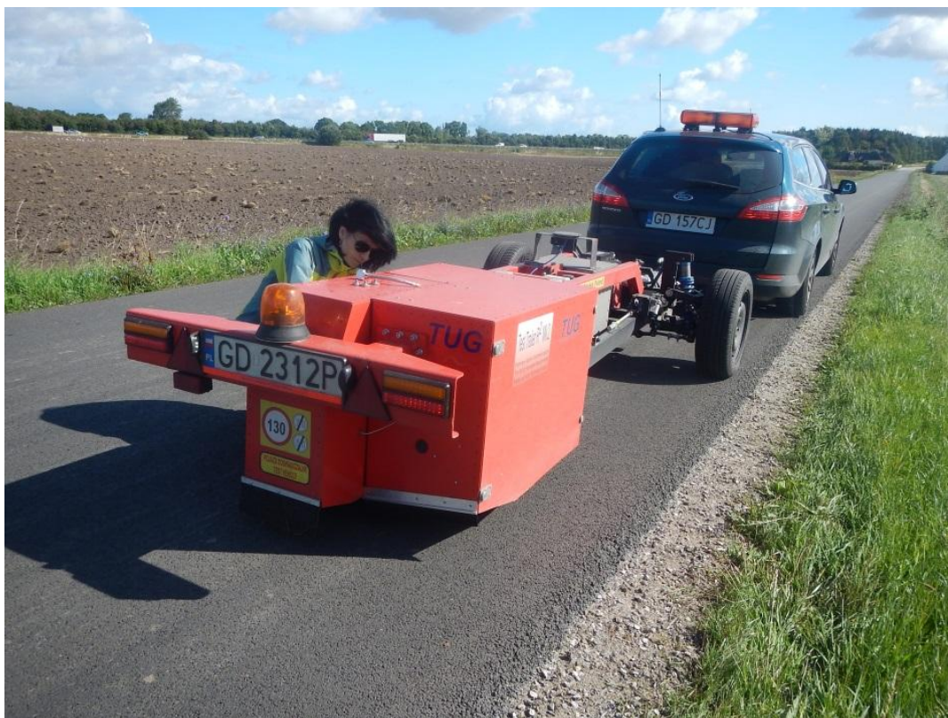
Rys.1 Przyczepa badawcza R^2Mk2 podczas badań na odcinku doświadczalnym w Danii.
