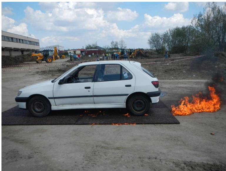
Rys.3 Badanie rozprzestrzeniania się ognia na nawierzchni poroelastycznej. Zdjęcie wykonane 30 sekund po podpaleniu 20 l benzyny rozlanej pod pojazdem. Wyraźnie widać, że na nawierzchni PERS płomień jest bardzo niewielki, podczas gdy z tyłu pojazdu, na nawierzchni betonowej jest on intensywny.
