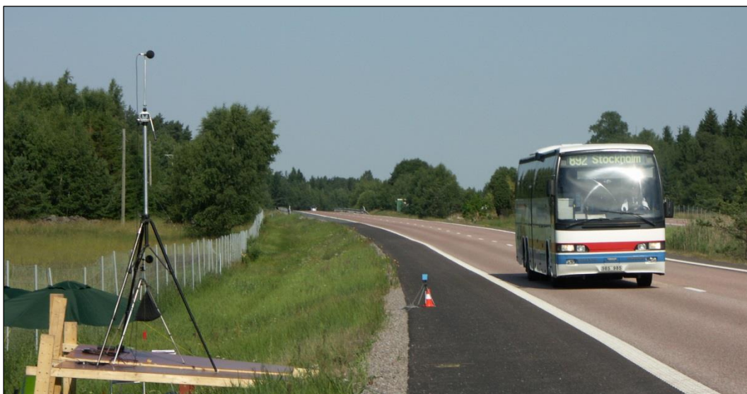
Rys. 1. Pomiary hałasu nawierzchni drogowej metodą statystycznego przejazdu (SPB) na autostradzie E18 w okolicach Sztokholmu w Szwecji
