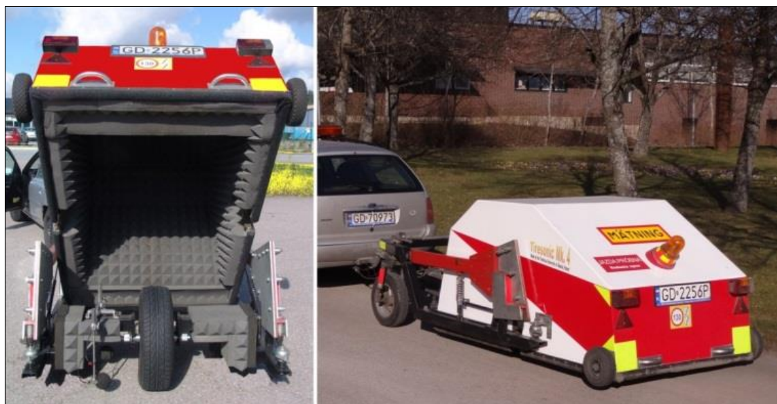
Rys. 6. Przyczepa pomiarowa Tiresonic Mk 4 do badania hałasu opon samochodowych i nawierzchni drogowych zaprojektowana i wykonana w Politechnice Gdańskiej
