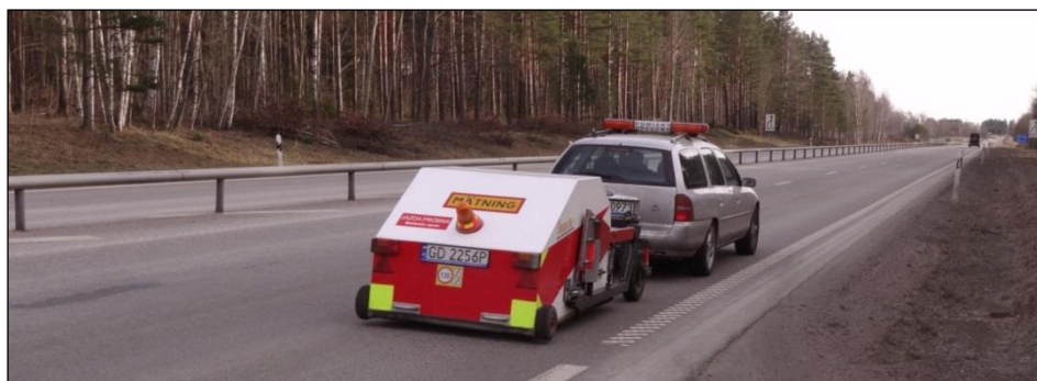
Rys. 2. Pomiar hałasu nawierzchni drogowej metodą CPX na drodze RV34 w okolicach Linköpingu w Szwecji
