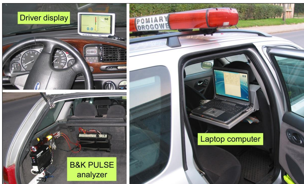
Rys. 7. System pomiarowy przyczepy badawczej Tiresonic Mk 4
