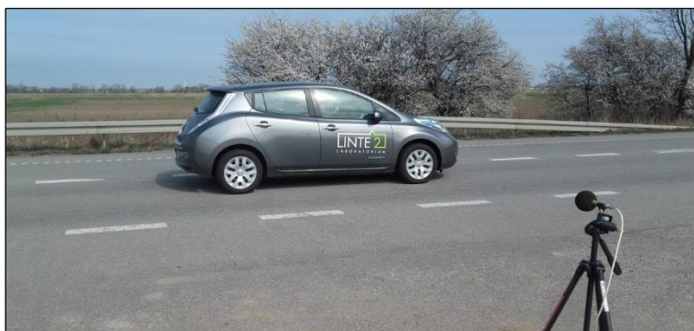
Rys. 14. Pomiar hałasu samochodów elektrycznych i hybrydowych metodą CPB (Controlled Pass-By)
