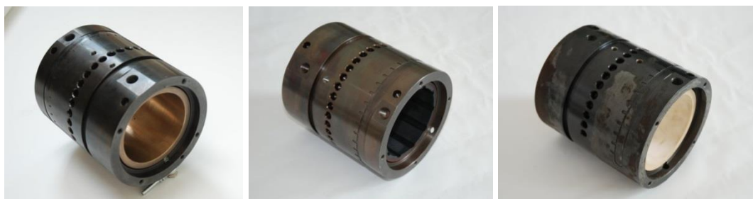
Rys. 7. Łożysko sztywne, gumowe i polimerowe przygotowane do badań porównawczych na stanowisku badawczym
