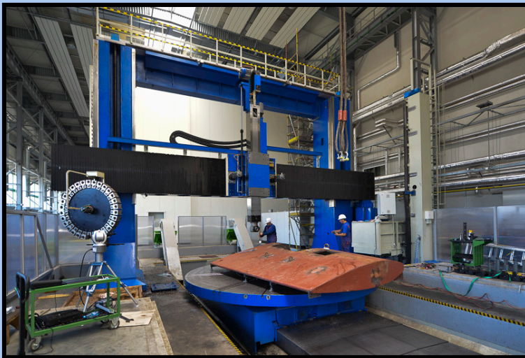
Example: Carousel lathe machine FKD 80/60 Feichter. Energomontaż-Północ Ltd Gdynia
